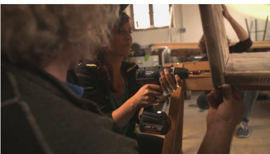
Rückenlehne mit Sitzfläche verkleben und anschrauben.
