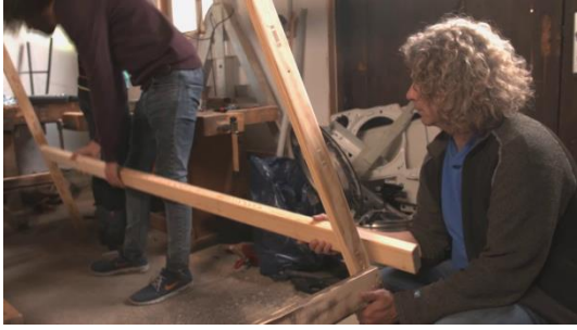
Ein zusätzlicher Querbalken für mehr Stabilität.
