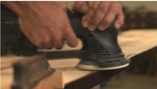
Alles abschleifen und lackieren.
